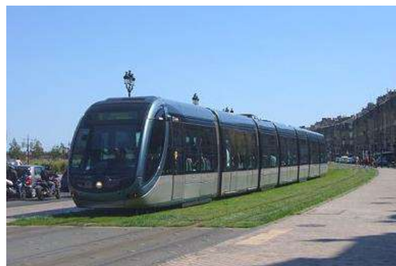
図 4-17 ボルドー(仏)の地表集電トラム
