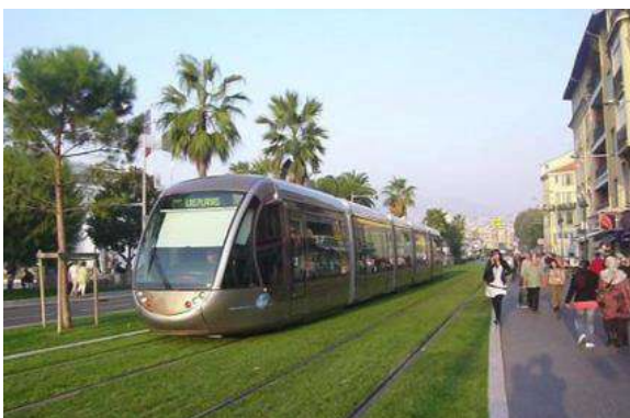
図 4-16 ニース(仏)のバッテリートラム
