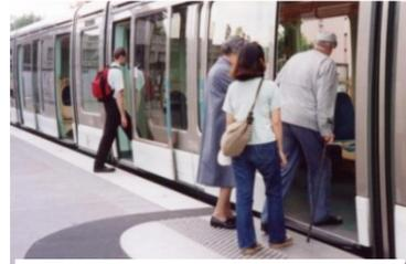
図 5-5 超低床式のLRT
