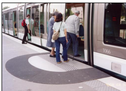
図 4-7 段差のない乗降口
