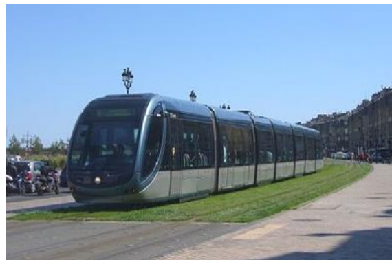
図 4-17 ボルドー(仏)の地表集電トラム
