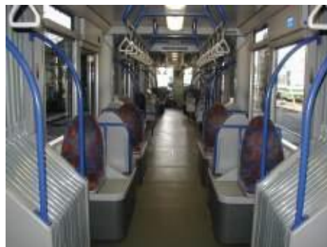
図 4-8 LRTの接続部分通路
